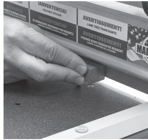
Abgeschrägte Messerkante zeigt auf Halteschrauben
